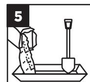
Agregue el contenido del saco poco a poco para que el polvo se integre al agua. Mezcle hasta obtener una pasta suave y homogénea.
