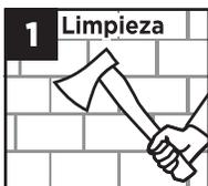
Usando un hacha elimine las boquillas de cemento expuestas.
